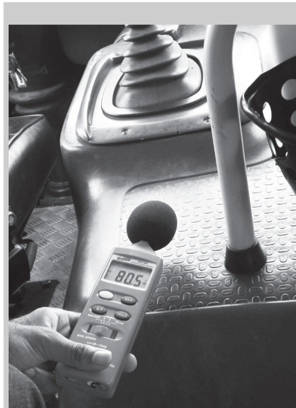
Medição do ruído na fonte e demais itens de medição em conformidade com a Norma Regulamentadora do Ministério do trabalho
